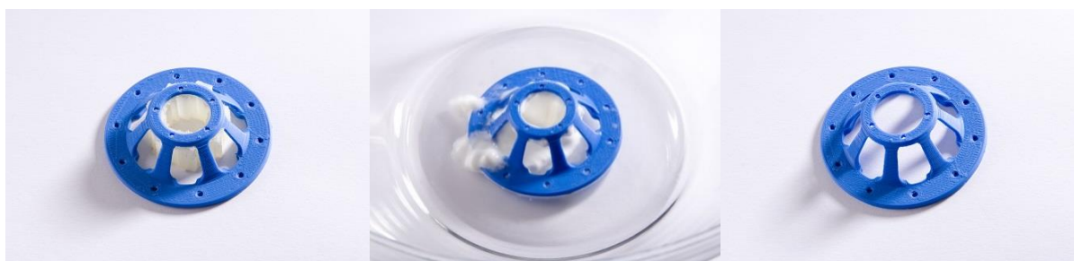
Abbildung 6: Links: Bauteil mit PVA-Stützstruktur; Mitte: Stützstruktur wird im Wasserbad gelöst; Rechts: fertiges Bauteil
